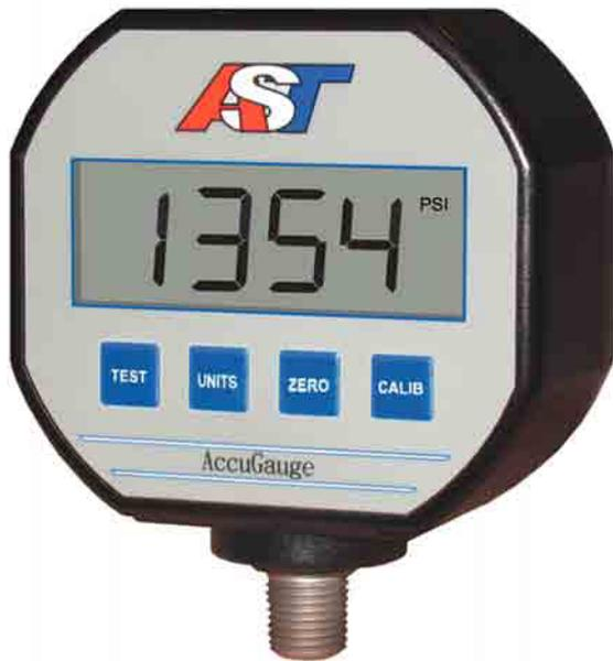
AG200 是一种介质与传感器及电信号之间隔离的数字压力表，提供4-20mA的输出信号，带有一个大LCD显示屏。AG200 采用**Krystal Bond**<sup>TM</sup>专有技术，具有和其它AST传感器相同的质量和性能，并且带有具背光功能的读出器。AG200 同样具有零点和满度校准选择，用户可重设量表，或根据具体需要调节校准点。
